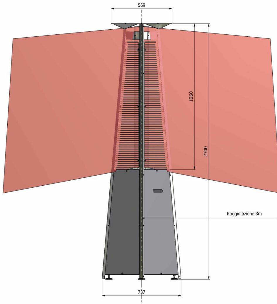
Под минимальной дистанцией понимается дистанция, которая позволяет размещать обогреватель или любой его компонент на расстоянии, гарантирующем пожарную безопасность. **Советуем соблюдать расстояние между потолком и верхней частью обогревателя не менее 0,5 метра.** Инфракрасный конус для получения идеального комфортного уровня составляет примерно 3 метра.
